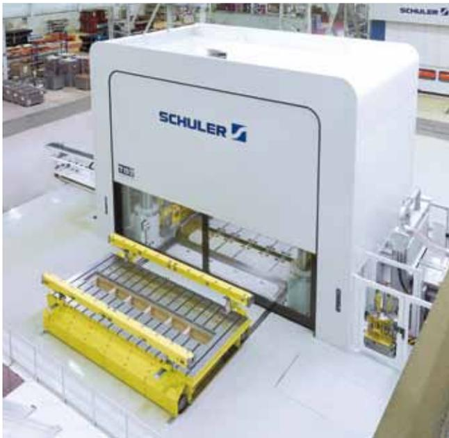
Die umweltschonenden Aspekte einer kompletten Schallkapselung, die Ölfreiheit im Arbeitsraum in Kombination mit einer deutlich verbesserten Sicht in dem Arbeitsraum machen die TST-Pressen zu einer bedienerfreundlichen Anlage.
