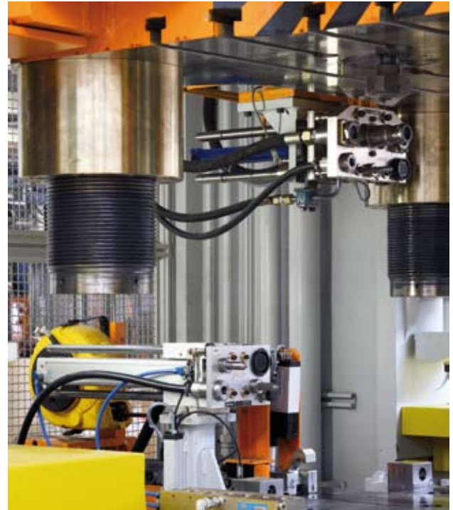
Schneller Werkzeugwechsel: Schnellkupplung-Werkzeughilfsfunktion.
