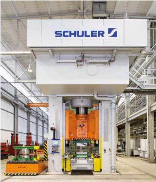
16.000 kN hydr. Ziehpresse zur Herstellung von Heizkesselteilen.
