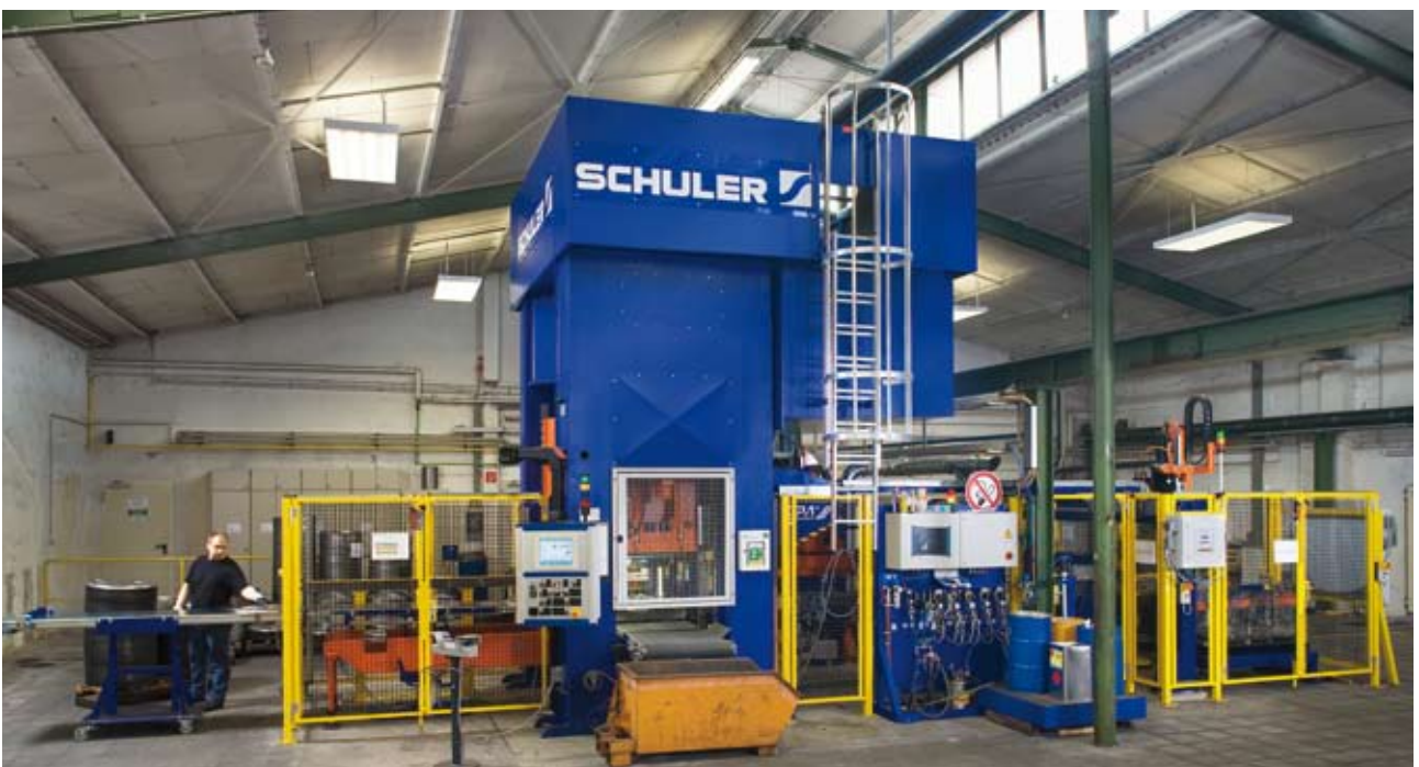
Automatisierte Fertigungszelle zur Herstellung von Fassdeckeln und -böden.
