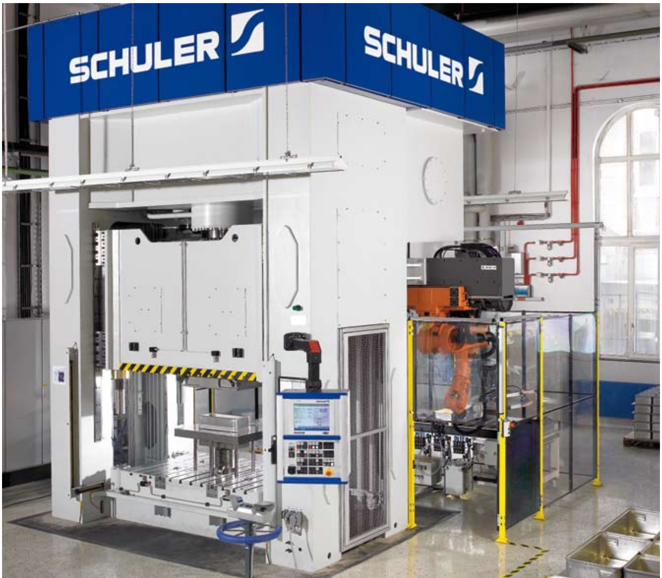
Roboterautomatisierte Einzelpresse für die Medizintechnik.
