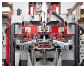
Elektronischer, modularer Drei-Achs-Transfer
