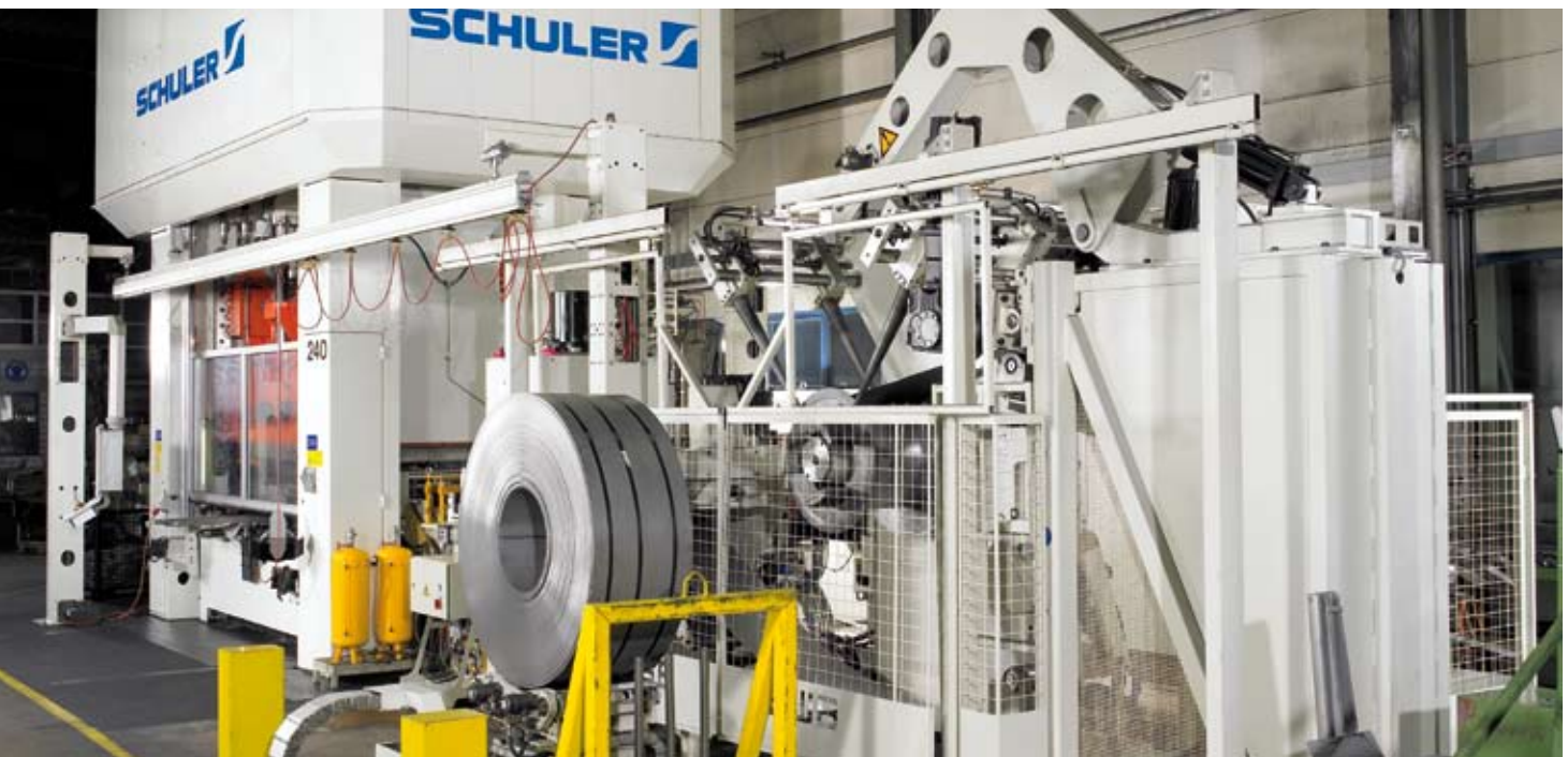
Bandanlage in Kurzbauf orm
