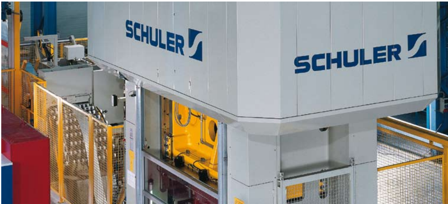
Kniehebelpresse mit Servoantrieb. Presskraft: 10.000 kN. Schuler Bandanlage in Kurzbauforn
