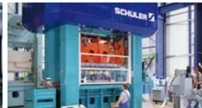
Kniehebelpresse mit Servoantrieb. Presskraft: 400 kN
