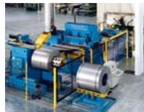
Bandanlage in Langbauf orm
