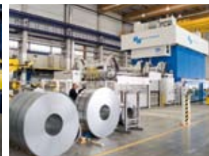
Servopresse mit Presskraft von 16.000 kN
