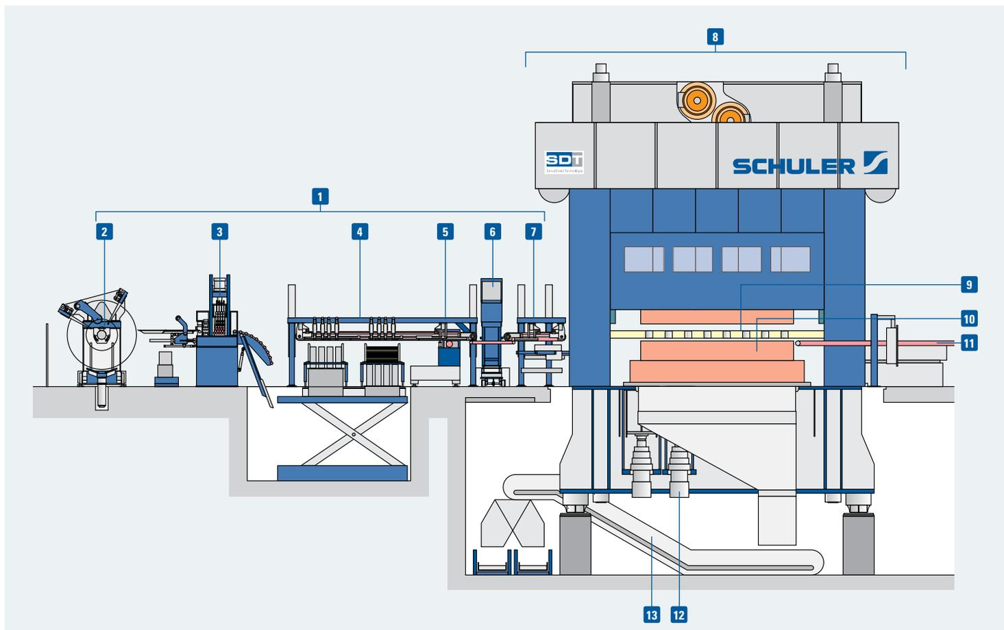
Servopresse mit Bandanlage und Platinenlader
