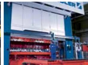
Servopresse mit Presskraft von 11.000 kN
