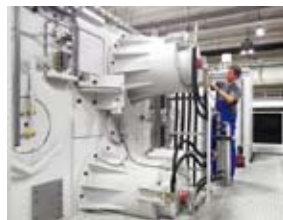
Antrieb mittels hochdynamischer Torquemotoren
