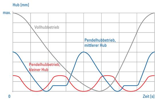
Die ServoDirekt Technologie ermöglicht die individuelle Programmierung der Stößelbewegung.
