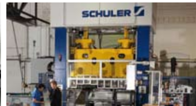
Servopresse bei Kortenbach GmbH, Presskraft: 2.500 kN
