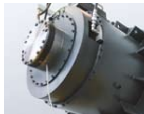
Antrieb mittels hochdynamischer Torquemotoren
