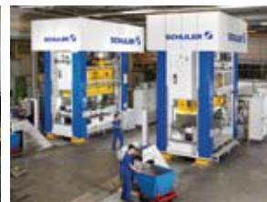
Servopressen mit 4.000 kN Presskraft
