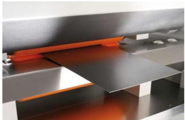
Die Walzenbeschichtung wird flexibel auf den Anwendungsfall ausgerichtet (z. B. Vliesstoffwalzen bei stark beölten Bandmaterialien).
