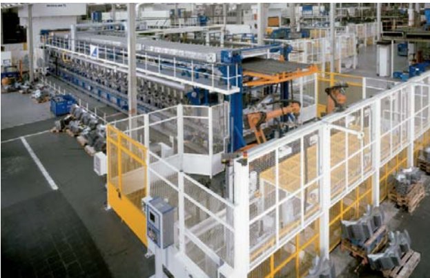
Zwei Roboter beladen den Rollendurchlaufofen mit Platinen oder vorgeformten Bauteilen.
