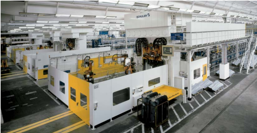
Roboterautomatisierte Fertigungslinien mit Rollendurchlauföfen und hydraulischen Pressen.
