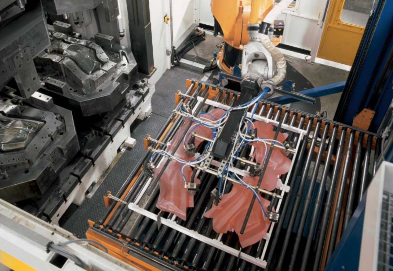
Vor der Umformung in der hydraulischen Presse werden die Bauteile auf ca. 930 °C erwärmt. Das Werkzeug ist zur kontrollierten Abkühlung der Bauteile mit einer Wasserkühlung ausgerüstet.
