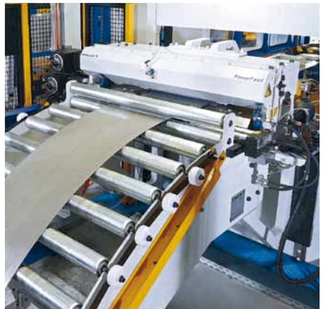
Hochdynamischer Walzenvorschub »Power Feed«.
