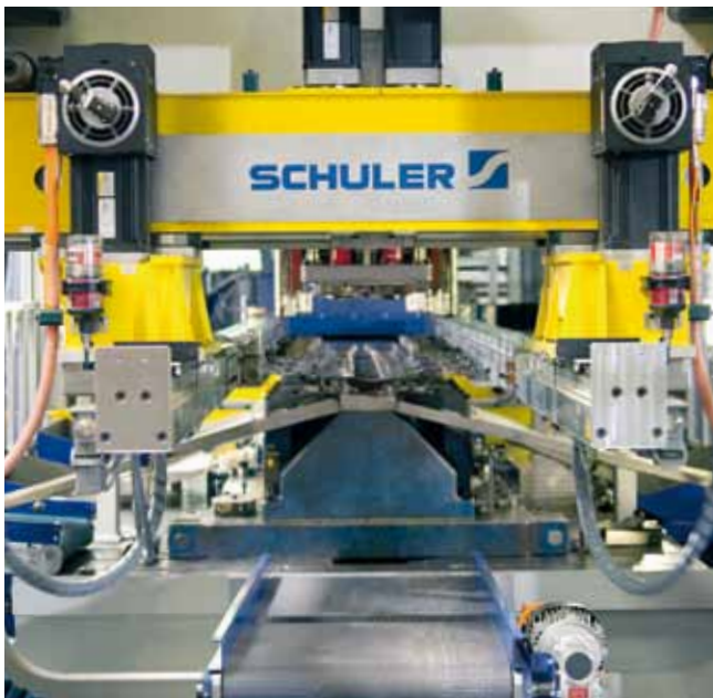
Drei-Achs-Transfer mit Servoantrieb.
