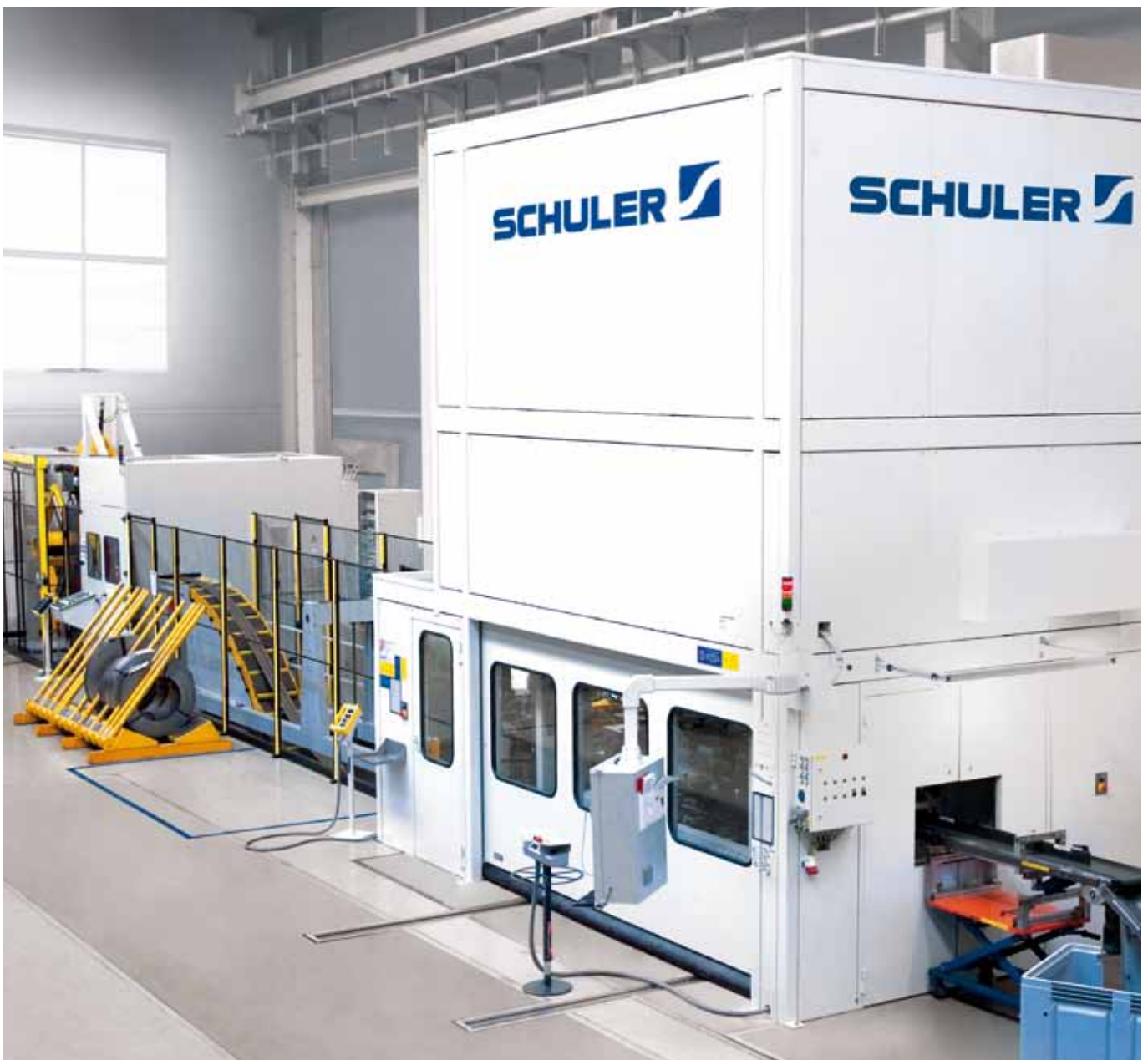
Kniehebelpresse mit Schallschutz-Verkleidung. Presskraft: 8.000 kN.
