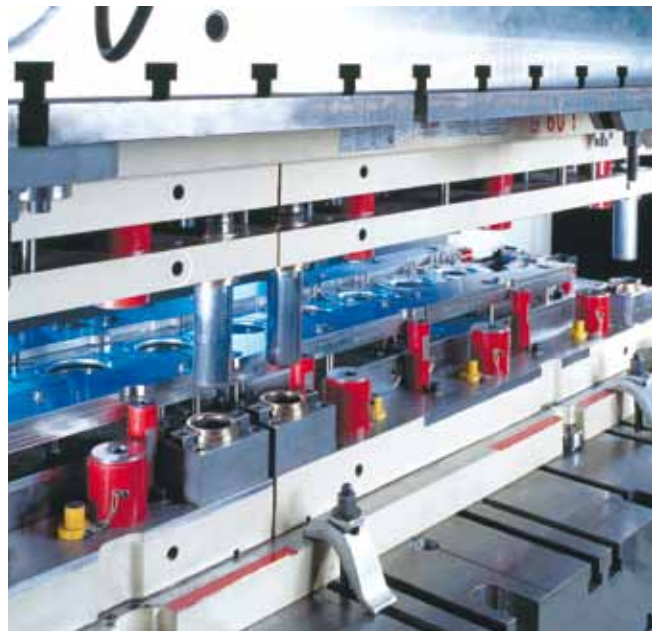
Werkzeugeinbauraum mit Folgeverbundwerkzeug.
