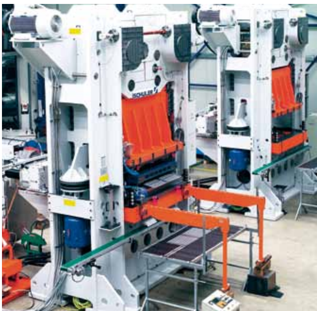
Heizkörperpresse RMK 1500 mit Doppelkniehebel-Oberantrieb.
