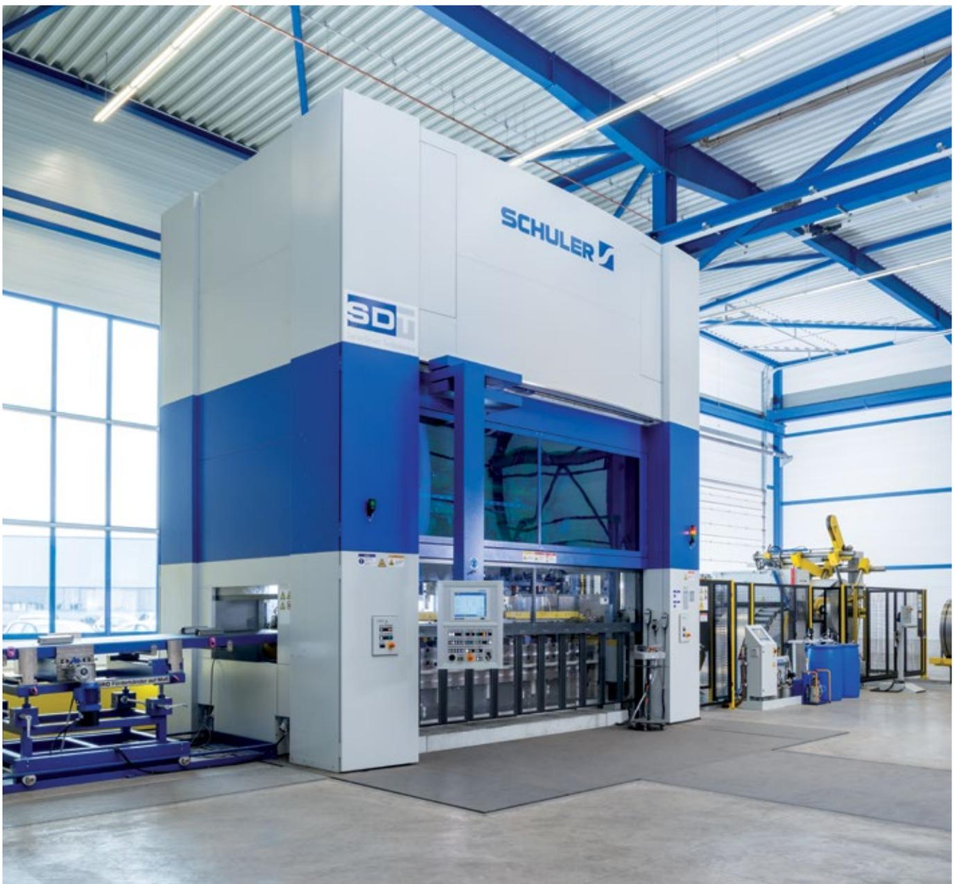
Servopresse in Monoblockbauweise im Process and Technology Center ProTec, Lennestadt. Presskraft: 6.300 kN
