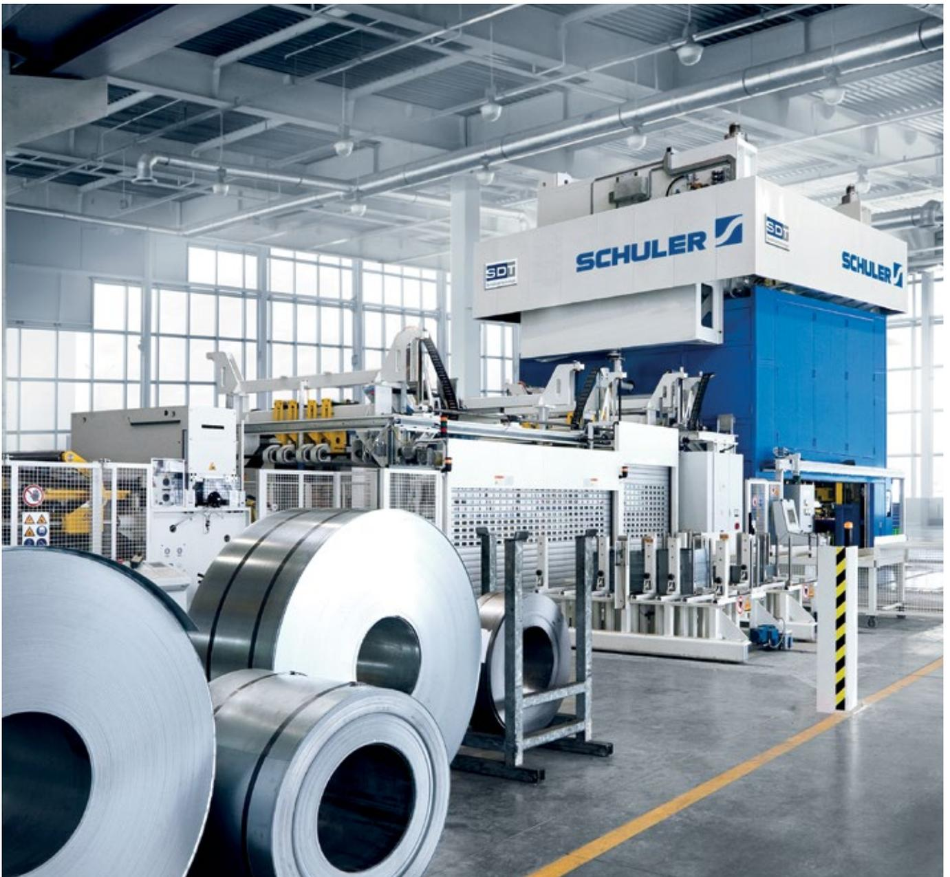
Produktion von Doppelteilen bei einem Automobilzulieferer. Presskraft: 16.000 kN.
