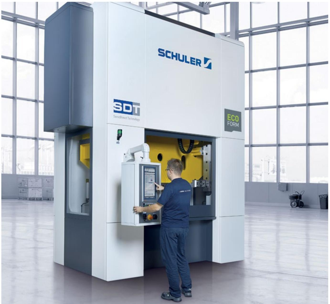
Doppelpleuel-Stanzautomat mit ServoDirekt Technologie MSC 2000.
