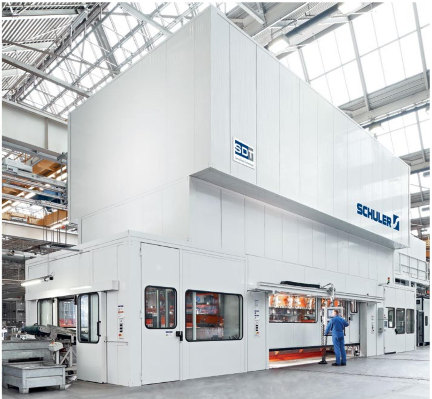
Servopresse in Zugankerbauweise bei einem Hausgerätehersteller. Presskraft: 16.000 kN.
