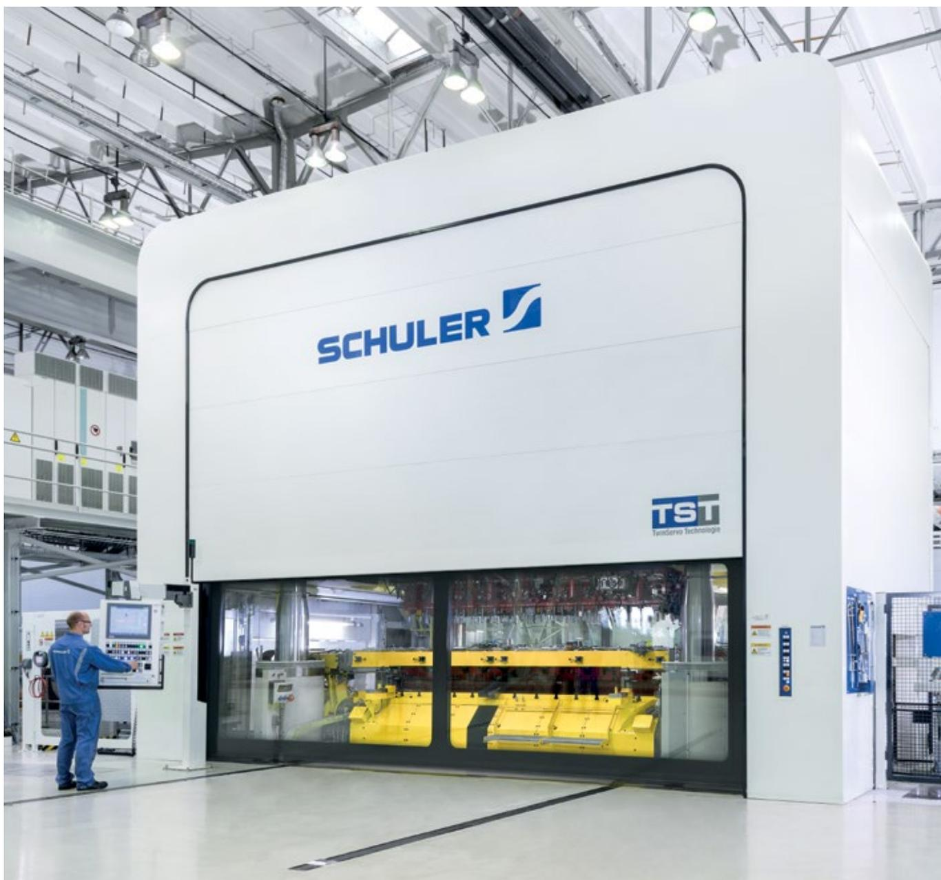
Transferpresse mit TwinServo Technologie im Schuler Servo TechCenter Erfurt.
