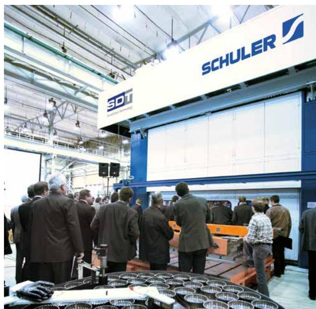
Erfahrungsaustausch an der automatisierten Transferpresse mit ServoDirekt Technologie.
