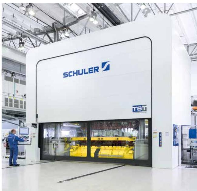
Transferpresse mit TwinServo Technologie im TechCenter Erfurt.
