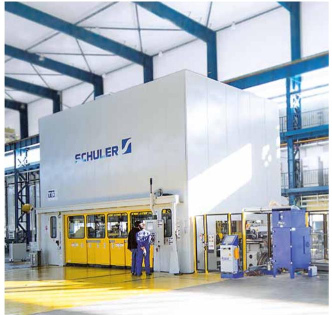
Automatisierte Transferpresse mit innovativer TwinServo Technologie.
