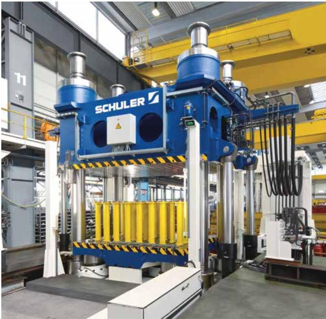
Hydraulische Composite-Pressen mit 18.000 kN Presskraft.
